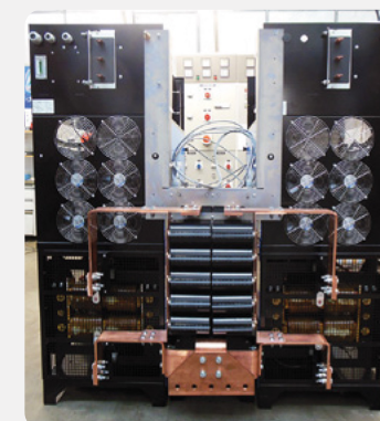
100 V 2,500 A (250 kW) pulsé à 250 Hz
