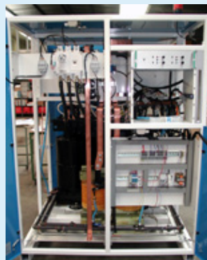
Redresseur pour accélérateur de particules
